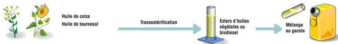
*Schéma de production des EMAG (Source : IFPEN)*
