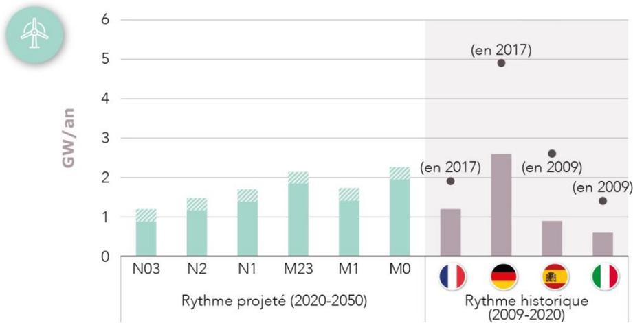
Figure 11 : Rythmes de déploiement de l'éolien terrestre par scénario de l'étude « Futurs énergétiques 2050 » et comparaison avec le rythme historique (Source : RTE « Futurs énergétiques 2050 »)
