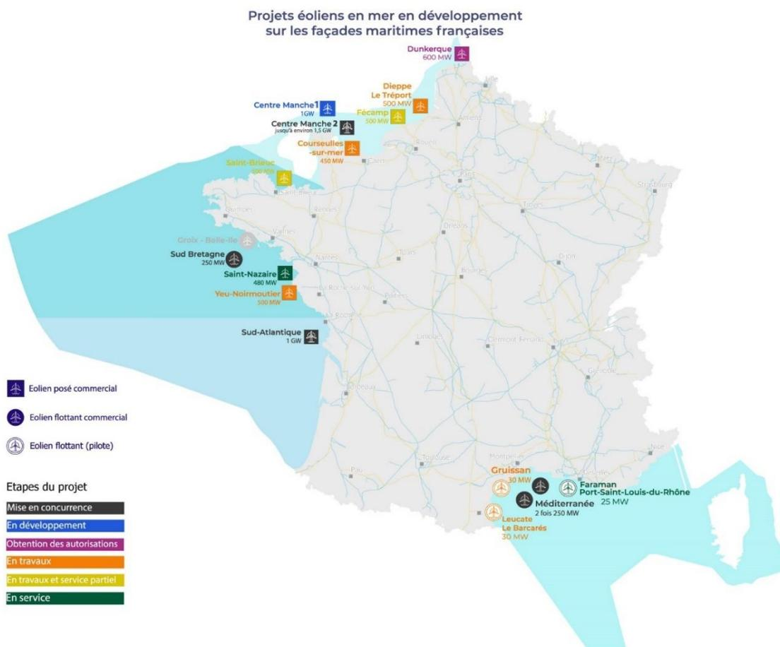
Figure 3 : Projets éoliens en mer en développement sur les façades maritimes françaises à l'horizon 2030 (Source : DGEC)
