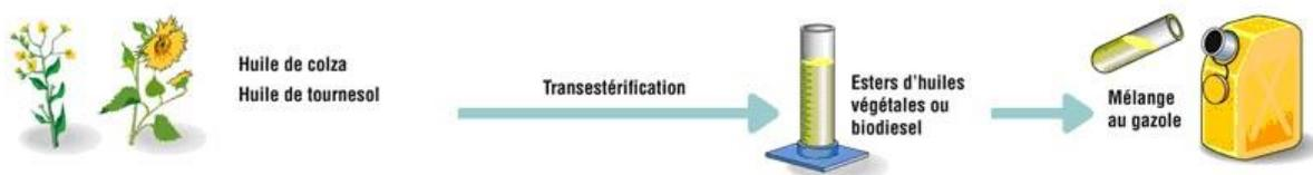
Figure 30 : Schéma de production des EMAG (Source : IFPEN)
