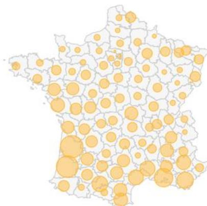
*Figure 12 : Puissance solaire totale raccordée par département au 31 décembre 2023*
