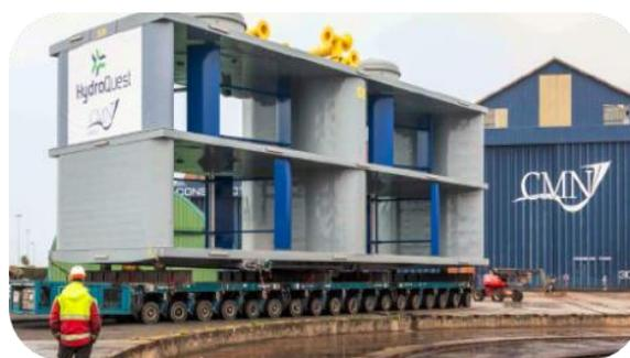
Photo 1 - Hydrolienne à axe vertical OceanQuest
